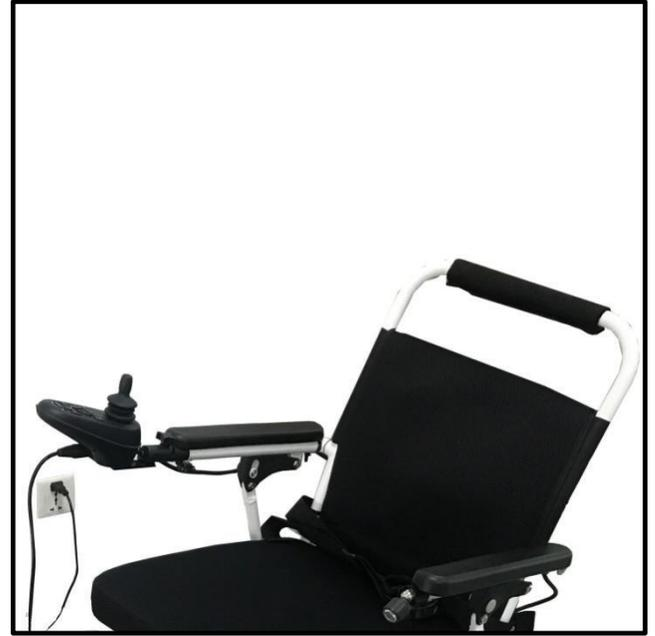
Figura 12. Carga de la batería con el cargador externo
